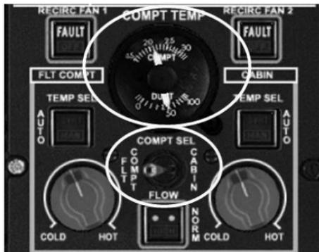
und wählen Sie mit dem Schalter darunter zuerst das FLT COMPT an und dann die Kabine (CABIN).
